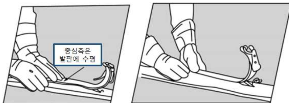
그림 4. 등목기 평판시험(Plane Test) 모형
