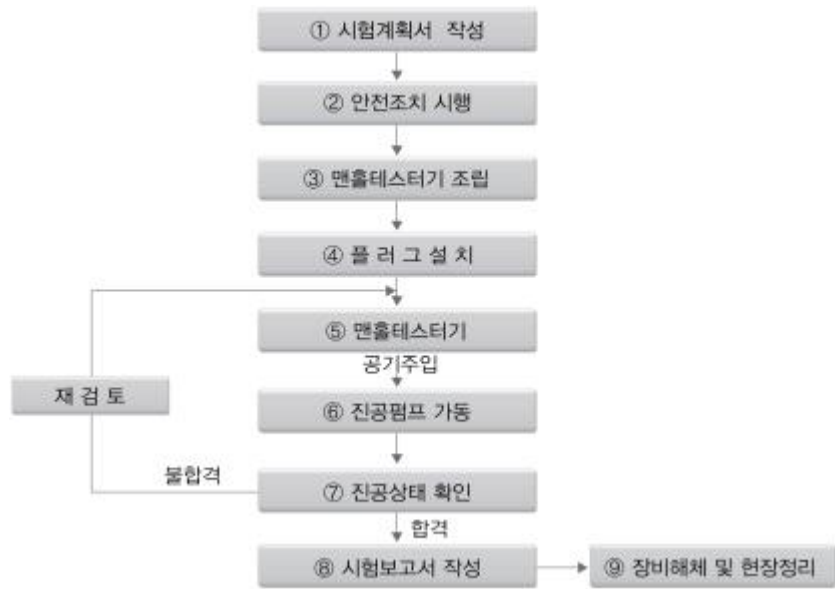
[그림 2-8-8] 맨홀 부공기압(진공시험) 절차모식도
